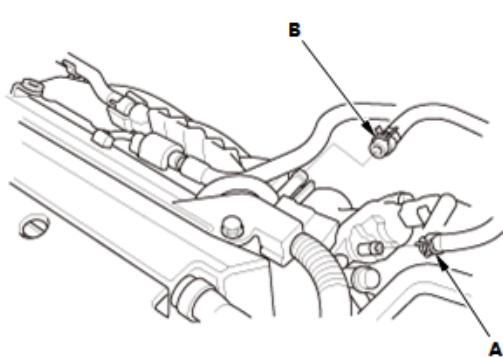
1. 断开连接 EVAP 碳管净化软管 (A) 和制动助力器真空软管 (B)。
