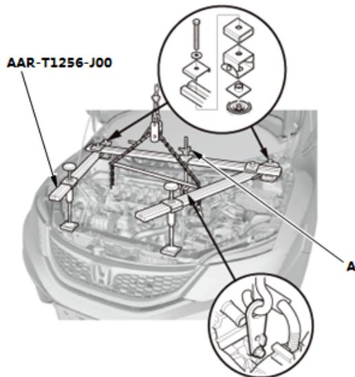
7. 发动机斜吊钩组件和第一辅助吊钩撑杆 - 拆卸
