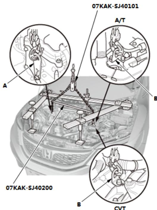
51.发动机支撑吊钩和第一辅助吊钩撑杆 - 拆卸
